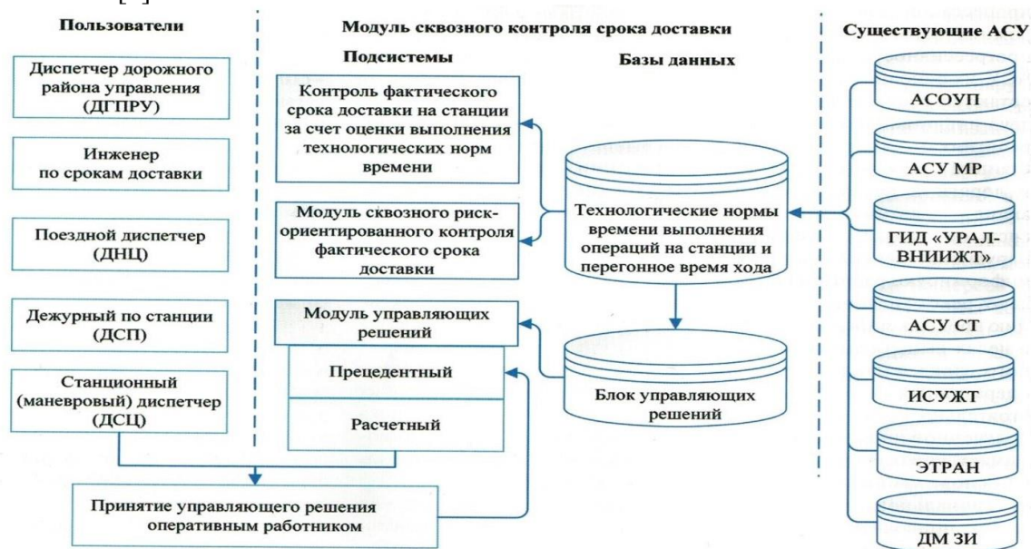
Рисунок 1 – Функциональная структура сквозного контроля срока доставки груза и схема взаимодействия с автоматизированными системами управления
